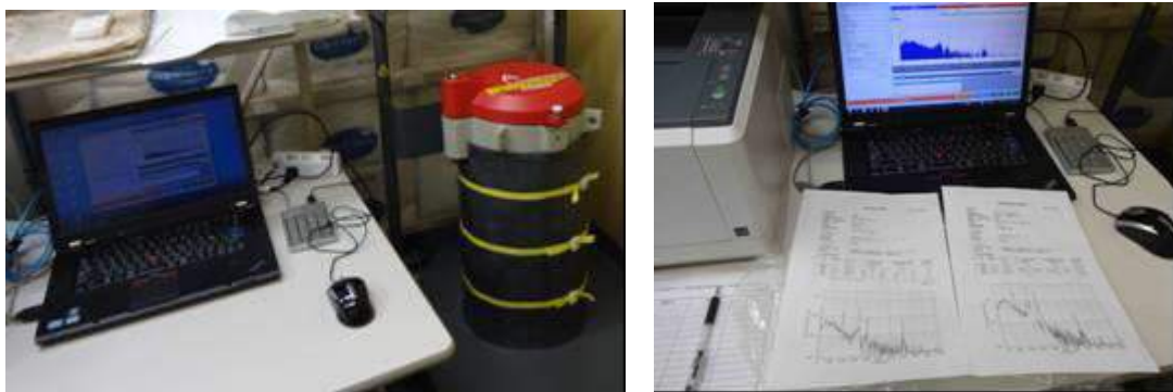
写真 9. 左) NaI シンチレーション測定器（日立アロカメディカル社製 Camberra）
